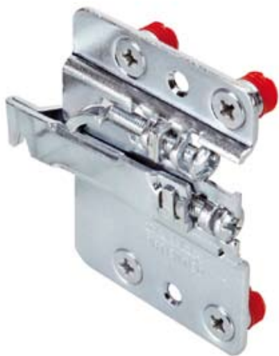
Zawieszki do szafek dolnych typ 807 zapewniają bezproblemowy dostęp do przestrzeni pod meblami i posiadają atestowany ciężar udźwigu 600 kg na komplet.
